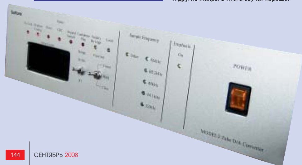
6 Внешний ЦАП японской фирмы Softone с ламповым выходным каскадом
